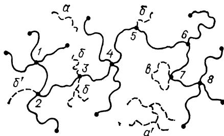
Рис. 6. Схематическое изображение участка реального сетчатого полимера:
